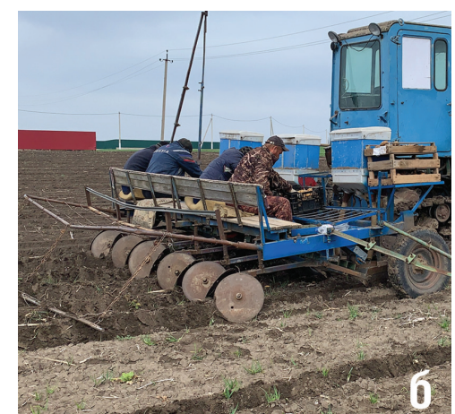
Фото 2. Замачивание клубней перед посадкой (а); посадка гусеничным трактором ХТЗ-181 (б)
